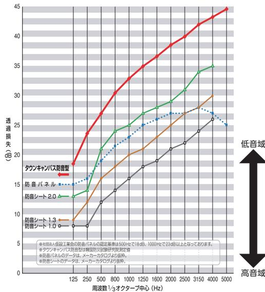
□ 遮音性能 (音響透過損失試験数値)
