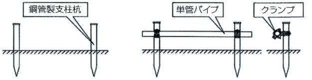
① 法面に鋼管製支柱杭を打ち込む。
