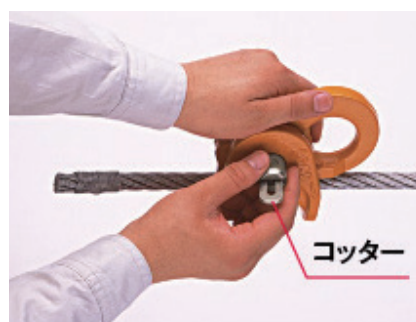
カムジクを通します。抜け防止のためコッターの頭部(幅広の方)を軽くハンマーでたたいてください。
