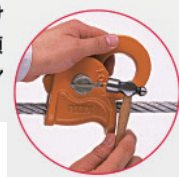
カムジクを通します。抜け防止のためコッターの頭部(幅広の方)を軽くハンマーでたたいてください。
