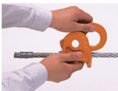
負荷側 (LOAD表示) の方向に荷重が掛かるようワイヤーをはさんでください。(反対方向では荷重は保持できません。)
