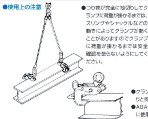
●つり荷が完全に地切りしてクランプに荷重が掛かるまでは、スリングやシャックルなどの動きによってクランプが動くことがありますのでクランプに荷重が掛かるまでは安全確認を怠らないようにしてください。
