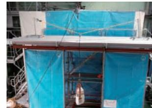
4) 墜落防護工安全基準(第2種)に基づく支柱の静荷重試験
