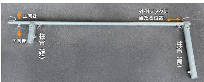
②フック部分は上向きに、伸縮パイプ固定蝶ネジは下向きにおき、柱管(長)が外側フックに当たる位置までスライドさせ、フレーム固定金具蝶ネジを締めます。
