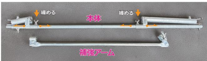
①フレーム固定金具の蝶ネジを緩め、スライドさせてパイプを広げます。
