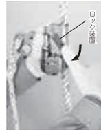
③ロック装置を矢印の方向に回し安全装置をロックする。
